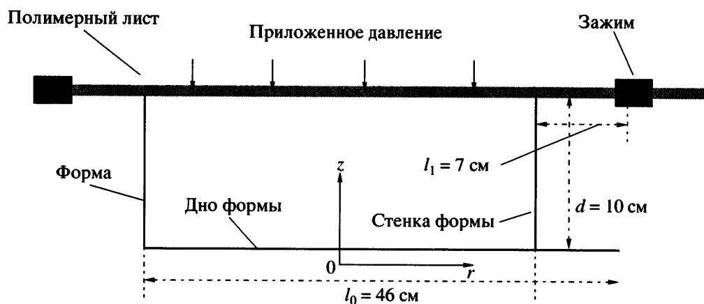
Рис. 1. Схема процесса термоформования полимеров под давлением.
