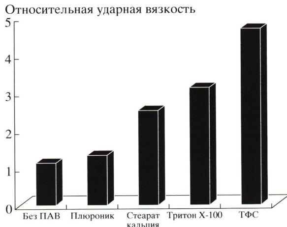
**Рис. 9.** Влияние природы ПАВ на степень упрочнения композита ПП–нано- $\text{CaCO}_3$  U1S2, содержащего 15 об. % наполнителя, при ударных нагрузках.
