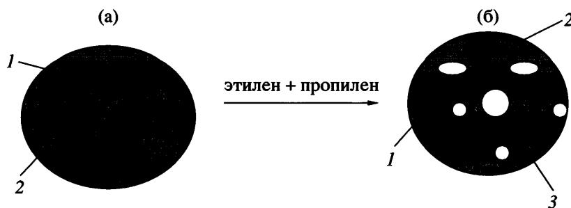
**Рис. 10.** Схема частицы изотактического ПП, полученного на стадии полимеризации пропилена (а), и частицы изотактического ПП, модифицированного сополимером этилен–пропилен в двустадийной полимеризации пропилена с последующей сополимеризацией этилена и пропилена (б) на ТМК: 1 – кристаллическая область ПП с частицами ТМК, 2 – аморфная область ПП с частицами ТМК, 3 – агломераты сополимера.
