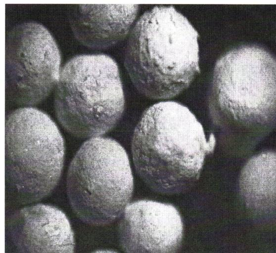
**Рис. 3.** Частицы ПП, полученные на катализаторе, нанесенном на микросферический макропористый стирол–дивинилбензольный гель.
