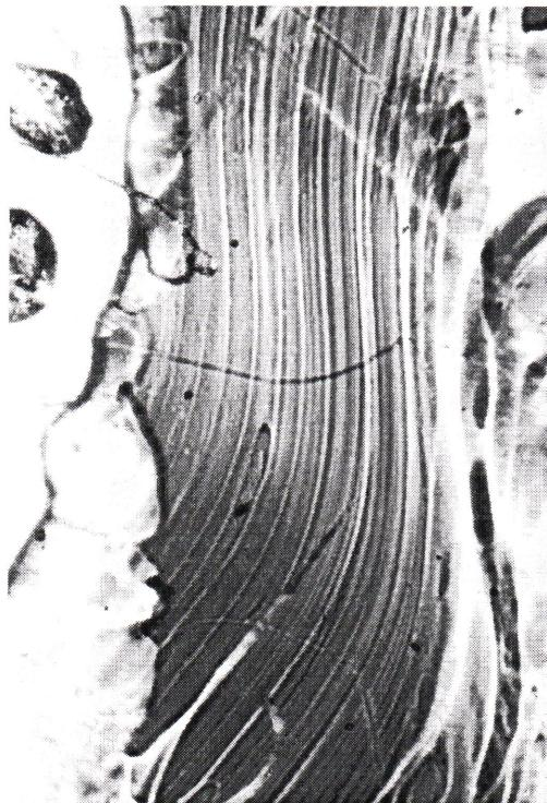
**Рис. 3.** Микрофотография раствора ГПЦ-1 в этианоле после деформирования. Увеличение 60.  $c = 45.0\%$ ,  $\gamma = 12 \text{ c}^{-1}$ . Поляроиды скрещены.
