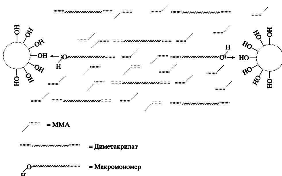
**Рис. 25.** Схема, иллюстрирующая механизм модификации материалов типа “Кориан”.
