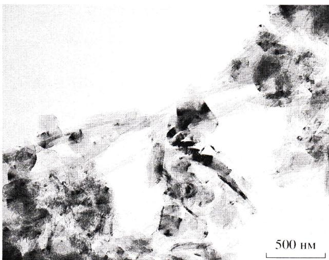
Рис. 1. ПЭМ-изображение образца окисленных углеродных нанотруб.
