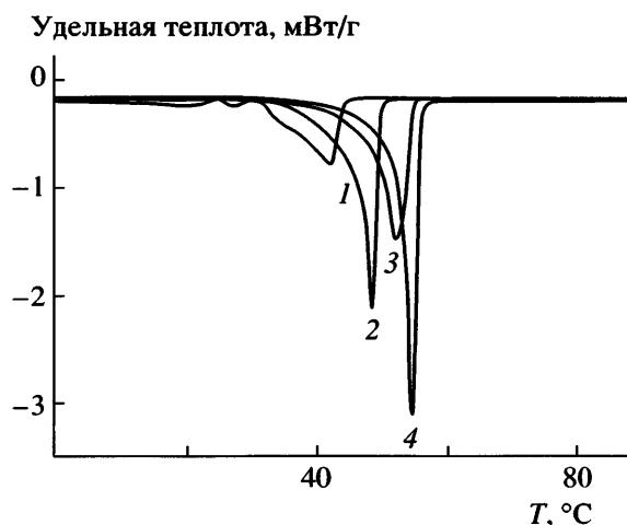
Рис. 4. ДСК-кривые макромономеров, полученных под действием 0.06 моль/л ДБДЛО при 90°C и отношении [КЛ] : [ГЭМА] = 5.2 (1), 10.5 (2), 15 (3), 21 (4).
