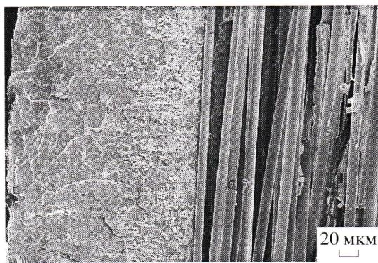
**Рис. 10.** Распределение частиц сажи при пултрузии.
