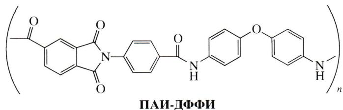
с  $M \sim 46 \times 10^3$ , синтезированный в Институте высокомолекулярных соединений РАН по известной методике [13]. Асимметричные мембранны получали методом мокрого формования в системе ПАИ-ДФФИ–растворитель (МП)–нерасторовитель (вода, этанол, изопропанол, этилацетат). Получено восемь вариантов образцов мембран (детали формования – в разделе “Результаты и их обсуждение”, таблица). Образцы 4 и 7 дополнительно подвергали отжигу при 423 К в течение 1 ч.
