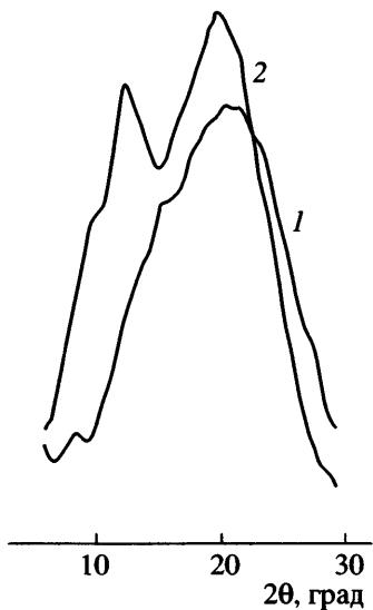
Рис. 6. Рентгеновские дифрактограммы пленок привитого сополимера хитозан-акриламида (1) и хитозана (2). [Акриламид]:[хитозан] = 3.
