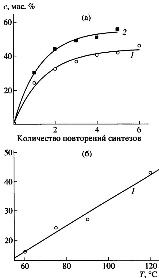
Рис. 3. Зависимости содержания с введенного в композит полипиррола от количества проведенных синтезов (а) и от температуры (б). 1 – ПЭ-1; 2 – ПЭ-2. Условия синтеза полипиррола: 20 МПа, 75 °С, 2 ч, пропитка в растворе  $\text{FeCl}_3$  в метаноле с концентрацией 1 моль/л.
