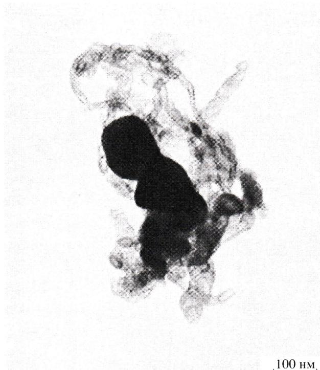
Рис. 3. Микрофотография бамбукообразных углеродных нанотрубок в структуре ИК-пиролизованный ПАН-Gd ( $T = 910^{\circ}\text{C}$ ,  $t = 2$  мин).
