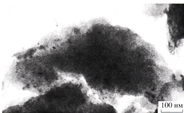
**Рис. 1.** Микрофотография нанокомпозита ИК-пиролизованный ПАН–Gd ( $T = 910^{\circ}\text{C}$ ,  $t = 2$  мин).
