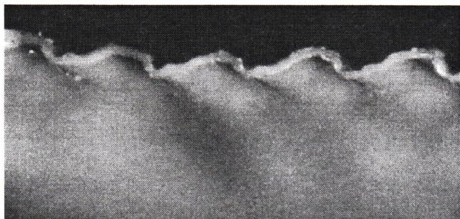
**Рис. 3.** Торец образца в области скачка фронта шейки. Разрез осуществлялся в направлении, показанном стрелкой на рис. 1.
