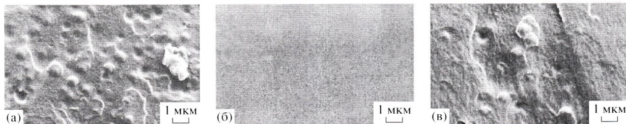
**Рис. 4.** Микрофотографии поверхности разлома эпоксифенольных пленок, полученных из композиций с различной длительностью форконденсации (ЭО:БДФО = 75:25 мас. ч. (БДФО – образец 3 из табл. 1), растворитель ЭО–этилцеллозольв, катализатор  $H_3PO_4$  вводили перед отверждением). Продолжительность форконденсации 0 (а), 1 (б) и 3 ч (в).
