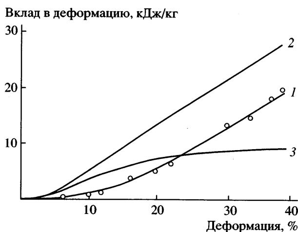
**Рис. 7.** Зависимость теплоты (1), механической работы (2) и запасенной внутренней энергии (3) от величины деформации одноосного сжатия ПС при 30°C и скорости деформации  $5 \times 10^2$  мин $^{-1}$  [29].
