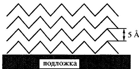
Рис. 8. Идеальная схема формирования структуры тонкой пленки ПВДФ с 4 монослями в полярной  $\beta$ -фазе.
