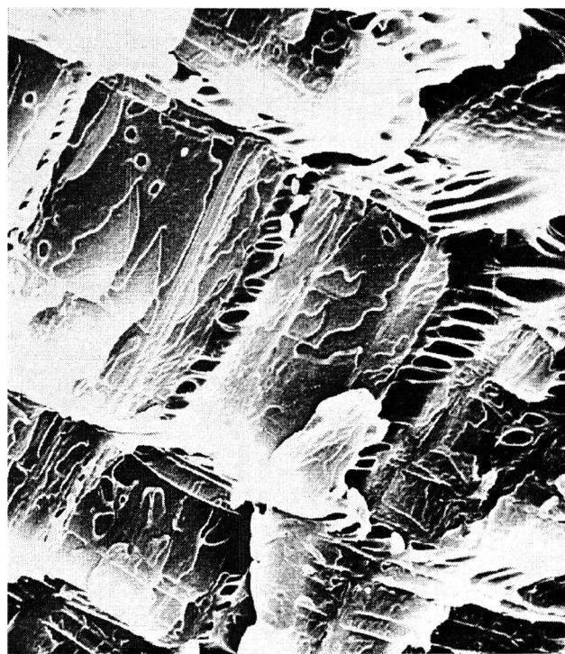
**Рис. 9.** Образование пор в полосах сдвига в неориентированной области полимера перед фронтом шейки.  $\times 1000$ .
