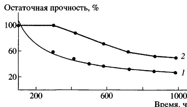
**Рис. 3.** Изменение прочности волокон в процессе окислительной УФ-деструкции ПКА ( $\lambda > 300 \text{ нм}$ ); 1 – волокно без ТПФП, 2 – волокно с добавкой ТПФП.
