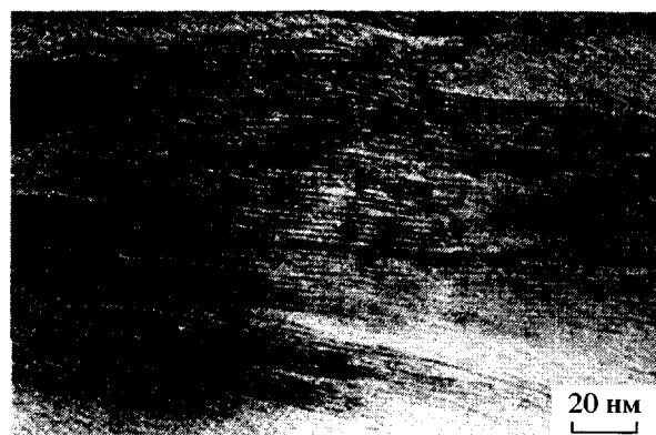
**Рис. 12.** Изображение ПЭМ углеродного остатка после сгорания нанокомпозита найлона-6.6 в условиях внешнего теплового излучения. Скорость тепловыделения 35 кВт/м<sup>2</sup> [57].
