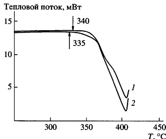
Рис. 5. Кривые ДСК термоокисления ПК без добавок (1) и с добавкой  $8.5 \times 10^{-3}$  моль/кг фуллера C<sub>60</sub> (2).
