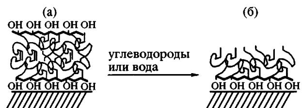
Рис. 3. Модель структуры тонких пленок гидроксилсодержащих ПДМС-щеток на поверхности оксида кремния: а – структура с гидрофильной поверхностью в слое толщиной 40 нм; б – монослой с гидрофобной поверхностью, образовавшийся после смывания избытка полимера растворителем или водой.
