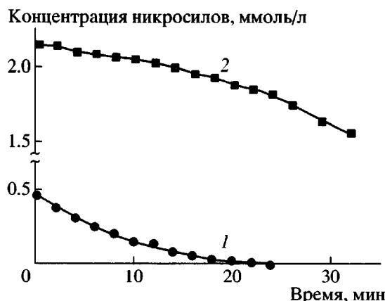
Рис. 3. Кинетические кривые расхода ТЕМПО (1) и макронитроксила NR· (2) в модельной системе стирол–пероксид бензоила (0.015 моль/л)–ТЕМПО–PNR при 50°C.
