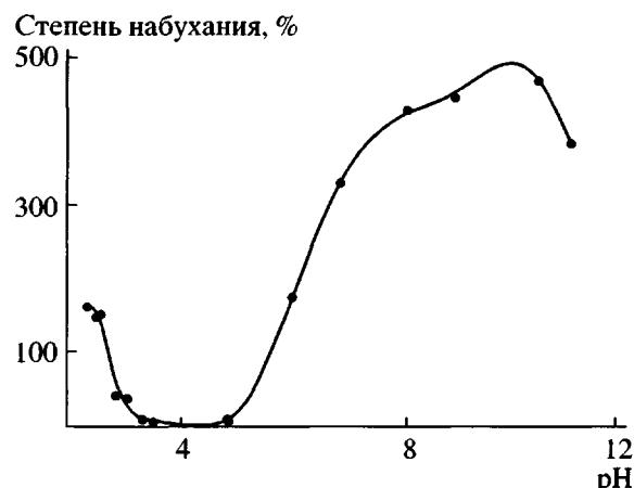
Рис. 3. Зависимость степени набухания от pH для сшитого сополимера ВИ–АК.
