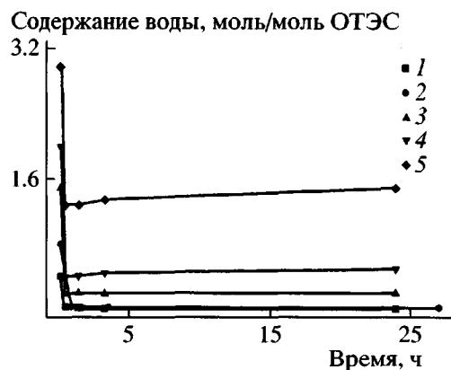
Рис. 1. Изменение содержания воды при гидролитической поликонденсации ОТЭС.  $[HCl] = 0.03$  моль/л, мольное соотношение вода : ОТЭС = 0.32 (1), 0.40 (2), 0.60 (3), 0.80 (4) и 1.00 (5).
