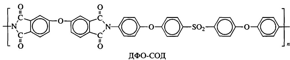
с  $T_c = 240^\circ\text{C}$  при объемном содержании волокна 50% имел прочность на изгиб при 20 и  $350^\circ\text{C}$  соответственно 1024 и 1420 МПа. Величина трещиностойкости  $G_{IC} = 1100 \text{ Дж}/\text{м}^3$ .
