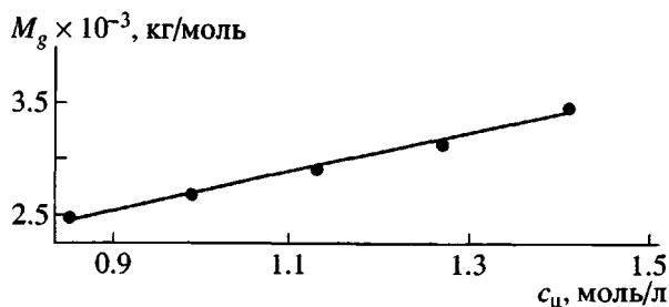
Рис. 2. Зависимость ММ синтезированных образцов ПАА при  $c_I = \text{const}$  от исходной концентрации мономера.
