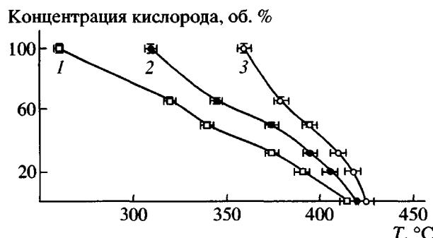
**Рис. 1.** Зависимость температуры начала термоокисления ПВХ при различном содержании кислорода в газовой фазе. Кратность газообмена 2 (1), 1.5 (2) и 1 (3).
