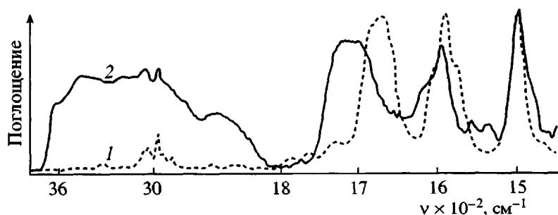
Рис. 1. ИК-фурье спектры полимеров IIIГ (1) и IVГ (2).
