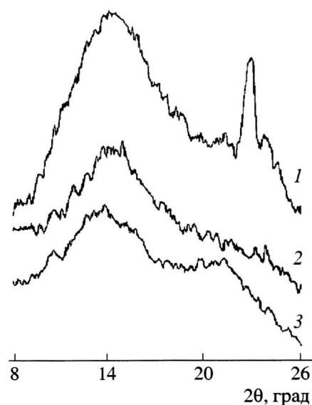
**Рис. 2.** Кривые рентгеновского рассеяния для немодифицированного СПФО (1) для СПФО, обработанного оксидантом (2) и для СПФО, модифицированного полипирролом (3).
