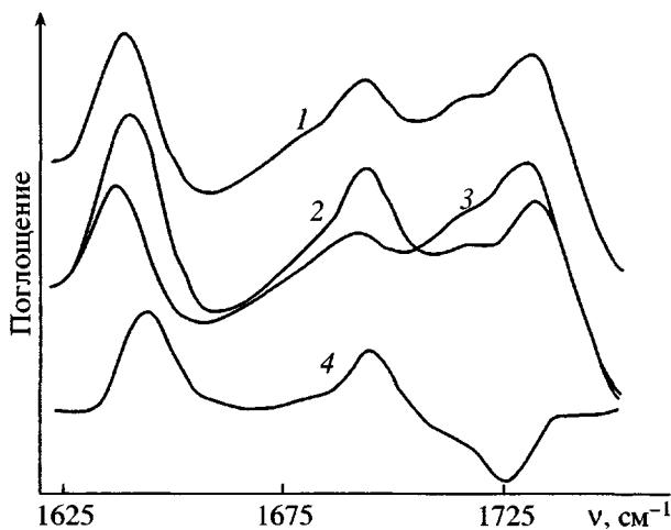
Рис. 4. Фрагмент ИК-спектра образцов СПУМ-3 (1), СПУМ-5 (2), СПУМ-1 (3) на основе форполимеров ФП-1, ФП-2 и их смеси (полоса Амид I). 4 – разностный спектр СПУМ-5 и СПУМ-1.
