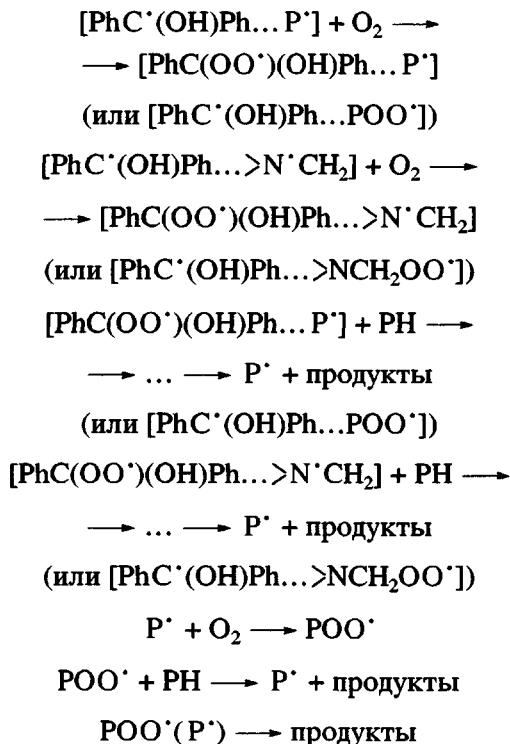
Радикальные пары, состоящие из кетильного и алкильного или аминильного радикала, с широким спектром времен жизни регистрируются в стеклообразных полимерах методом лазерного фотолиза [11, 12].
