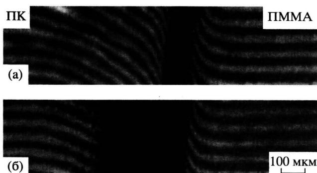
**Рис. 3.** Интерферограммы для системы ПК–ПММА ( $M_w = 1.5 \times 10^4$ ), полученные при понижении температуры.  $T = 220$  (а) и  $160^\circ\text{C}$  (б).
