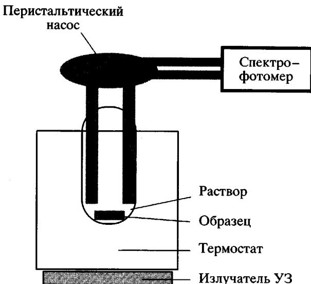
**Рис. 1.** Схема ячейки для исследования воздействия ультразвука на активность иммобилизованного трипсина в термочувствительном гидрогеле.
