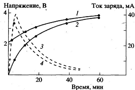
Рис. 3. Зарядные характеристики элемента: 1, 2 – напряжение заряда, 3, 4 – ток заряда. Ячейки типа литий–полиацетилен (1, 3) и полиацетилен–полиацетилен (2, 4).
