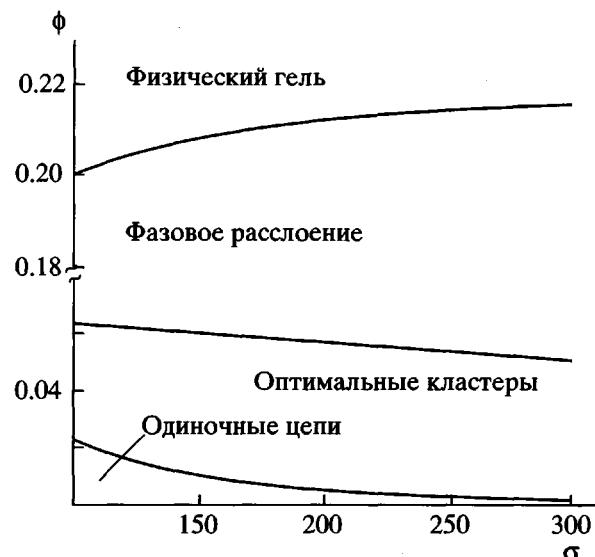
Рис. 11. Фазовая диаграмма ассоциирующего полимера с большим числом стикеров в переменных средней объемной доле полимера в системе  $\phi$  – расстояние между заряженными группами  $\sigma$  при фиксированном числе стикеров.  $N = 1000$ ,  $l = 20$ ,  $u = 1$ .
