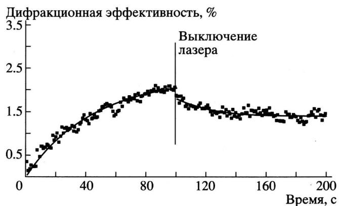
Рис. 29. Рост дифракционной эффективности первого порядка в ходе голографической записи (Аг-лазер, 514 нм, 143 мВт/см<sup>2</sup>).
