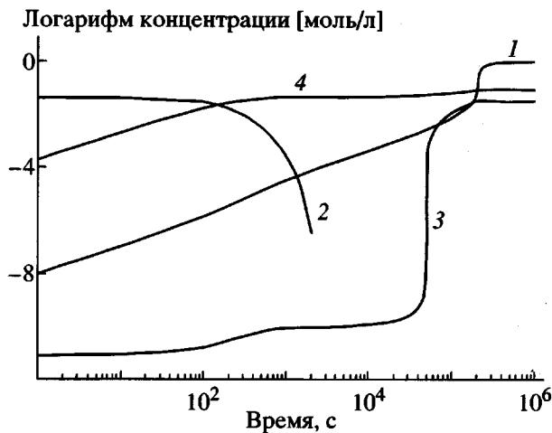
**Рис. 5.** Кинетика полимеризации, рассчитанная с использованием кинетических констант работы [2]. 1 – глубина превращения, 2 – концентрация инициатора, 3 – концентрация активных и 4 – "спящих" радикалов.
