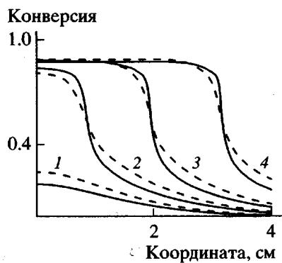
Рис. 4. Теоретические конверсионные профили, рассчитанные для температурного профиля рис. 1. Время полимеризации: 1 (1), 2 (2), 4 (3), 104 (4). Пояснения в тексте.
