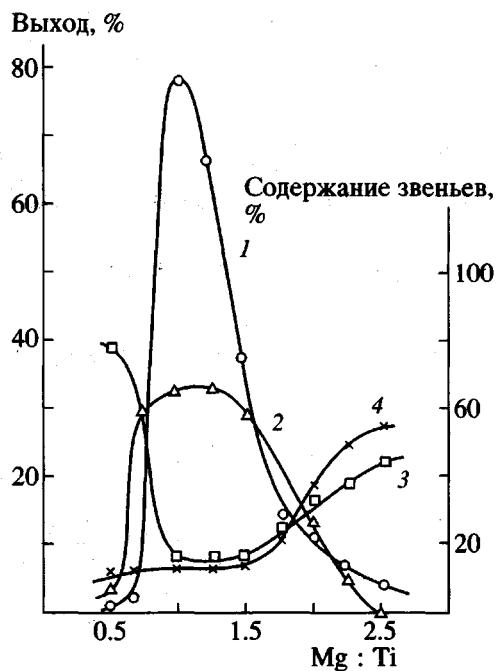
Рис. 1. Зависимость выхода (1) и микроструктуры (2–4) ПБ от соотношения компонентов катализатора  $TiI_2Cl_2-MgRR'$ : 2 – 1,4-циклические, 3 – 1,2-, 4 – 1,4-транс-звенья. Время полимеризации 1 ч,  $c_{Ti} = 3 \times 10^{-3}$ ,  $c_m = 1.0$  моль/л.
