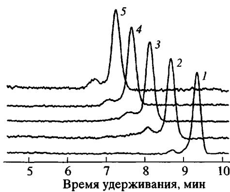
Рис. 3. Кривые ГПХ дендримеров с аллильными концевыми группами: 1 –  $\text{Si}_5^8$  (All), 2 –  $\text{Si}_{13}^{16}$  (All), 3 –  $\text{Si}_{29}^{32}$  (All), 4 –  $\text{Si}_{61}^{64}$  (All), 5 –  $\text{Si}_{125}^{128}$  (All).
