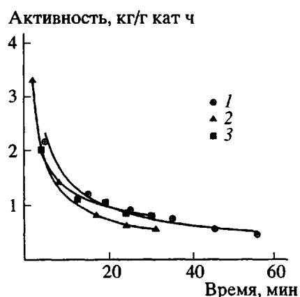
Рис. 4. Кинетические кривые гомополимеризации этилена (1) и его сополимеризации с норборненом (2, 3) на BMK. Давление этилена 3.5 ати, водорода 0.5 ати,  $T = 80^\circ\text{C}$ , концентрация норборнена 16 (2) и 36 г/л (3).
