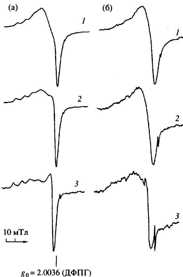
Рис. 3. Спектры ЭПР твердых комплексов ПАК (а) и ПВТ (б) с  $\text{Cu}(\text{NO}_3)_2$  при  $20^\circ\text{C}$  и соотношение лиганд : металл = 20 : 1 (1), 50 : 1 (2) и 100 : 1 (3).
