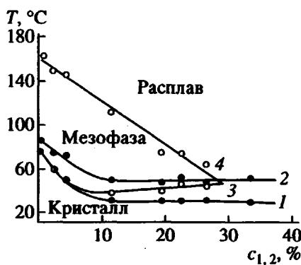
**Рис. 6.** Зависимость температуры начала и конца фазовых переходов сополимеров ТПБ от содержания виниловых групп в макромолекулах. Кривые 1 и 2 – температуры начала и завершения плавления кристаллитов соответственно, 3 и 4 – температуры зарождения мезофазы и ее плавления.
