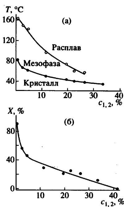
Рис. 2. Зависимость температур первого и второго фазового перехода (а), а также степени кристалличности X сополимера (б) на основе ТПБ от содержания 1,2-звеньев c<sub>1,2</sub> в макромолекулах.
