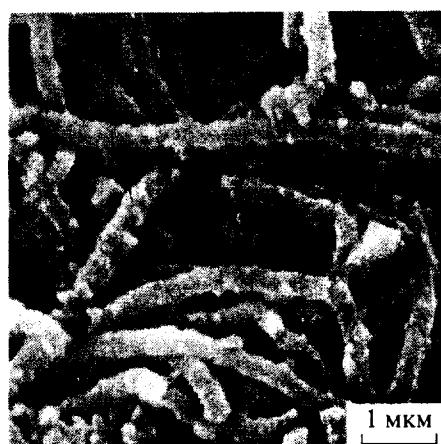
Рис. 6. Электронно-микроскопическая фотография полianiлина, полученного при полимеризации вне пористой матрицы.
