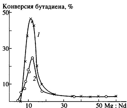
Рис. 1. Зависимость конверсии бутадиена от соотношения Mg : Nd при полимеризации в толуоле (1) и в гептане (2) на катализаторской системе  $\text{NdCl}_3 \cdot 3\text{TBF}-\text{MgRR}'$ .  $[\text{C}_4\text{H}_6] = 1.3$  моль/л,  $[\text{Nd}] = 0.7$  (гептан) и 1.2 ммоль/л (толуол), продолжительность полимеризации 4 (толуол) и 5 (гептан) суток.
