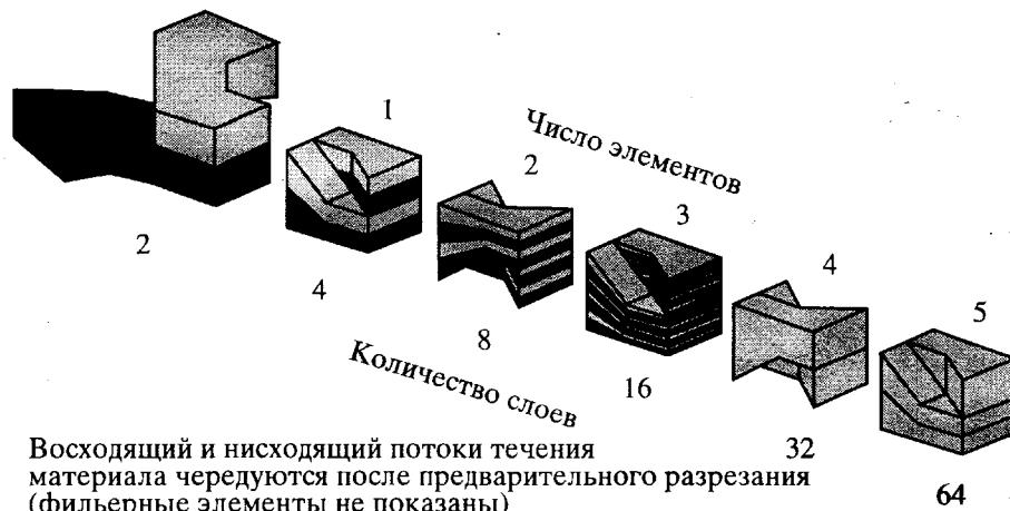
**Рис. 9.** Схематическое изображение течения двух различных полимеров через коэкструдирующую ячейку и пять фильтрных элементов, используемых для создания слоевого полимер-полимерного композита, содержащего до 64 чередующихся слоев.
