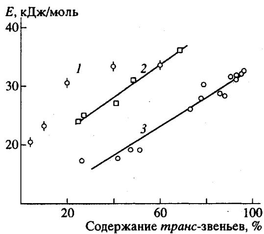
Рис. 4. Зависимость энергии активации вязкого течения от микроструктуры полимера. 1 – полибутадиен [12], 2 – олигооктадиенилен, 3 – олигопентенилен.
