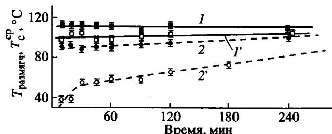
Рис. 2. Зависимость средней температуры стеклования  $T_c^{\text{ср}}$  (1, 2) и температуры размягчения  $T_{\text{размягч}}$  (1', 2') от времени прессования для образцов СТП-1 (1, 1') и СТП-2 (2, 2').
