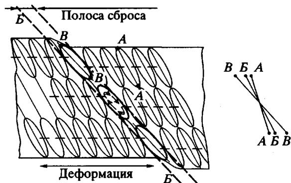
Рис. 6. Схема преобразования реперной сетки при переориентации (деформация через полосу сброса). АА, ББ, ВВ – направления соответственно: осей макромолекул в исходном образце, границы полосы сброса, осей макромолекул в полосе сброса.
